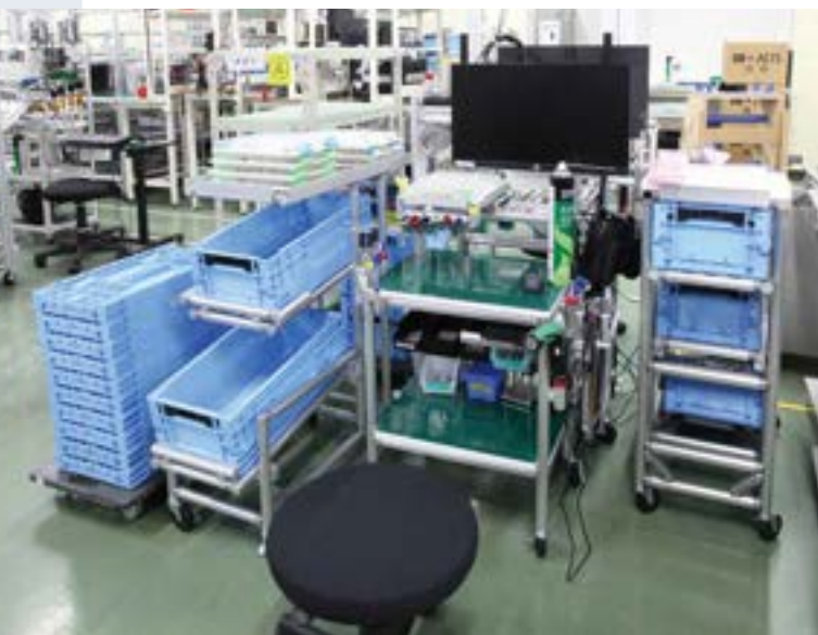
低い位置で行う調整作業に合わせて、座ったまま使えるようにつくられた作業台とシューター。天板の周辺や下に部材や道具が配置されているのが見える。
