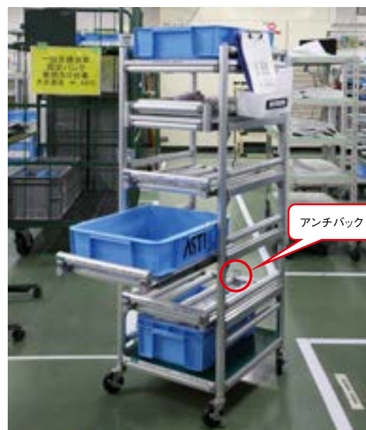
段取りした部材を載せて工程へ運び、引き出して取り出せる台車。アンチバックで落下を防止しつつスムーズな積載を実現。
