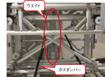
台車背面には動滑車+ウエイトを設置。足元に付けたガスダンパーは、GF製のリンク機構を介して荷台を押し上げる。
