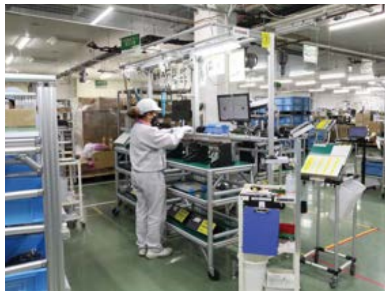
パソコンやライトが設置された正面の台と、製品を載せた手前の台車は分かれており、作業が完了したら載せ替えをせず、そのまま次の工程へと運ぶことが可能。
