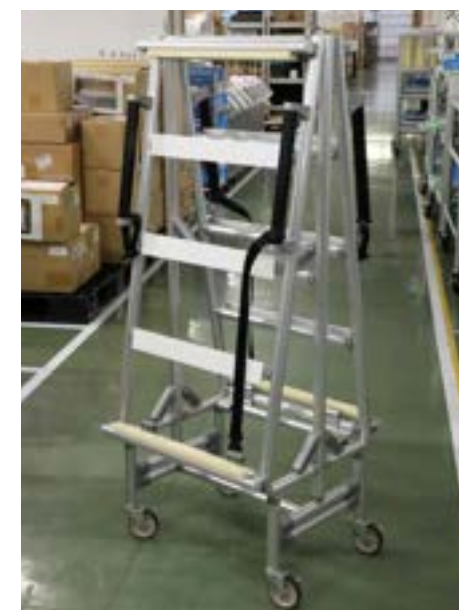
1,000mmほどの長物を運ぶ専用台車。上下の樹脂の溝にワークをはめ込み、ベルトを止めて、運搬する。
