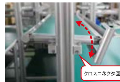
② クロスコネクタ回転により、棚の角度調整が可能
