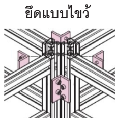
ประกอบ Plate Bracket โดยการสอดเข้าไปในร่องของเสา
