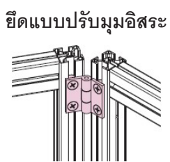
ขันยึดสกรูที่ Plate Bracket ให้แน่นด้วยประแจหกเหลี่ยม
