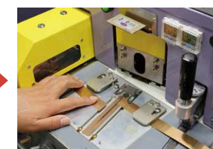
装置のガイドに従い、それぞれ末端を切り落とし素材を溶接部にセッティング。
