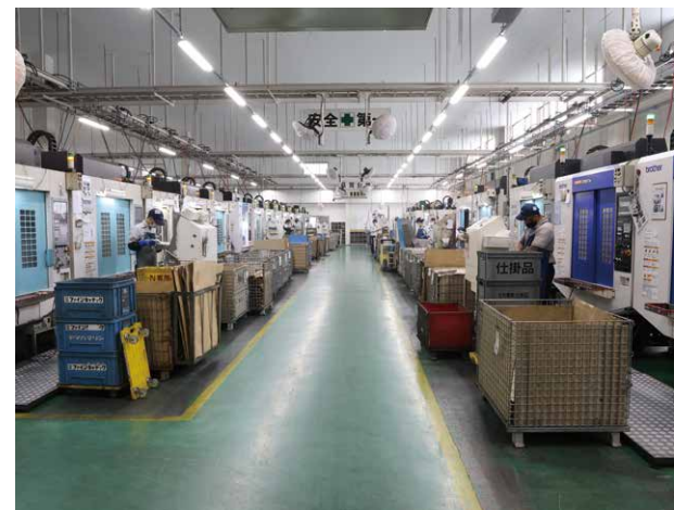
タッピングセンタが並ぶ加工の現場。複数台を1人の作業者が受け持ち、加工が終わると通路側にあるブースに運んでエアブローを行っている。
