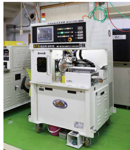
小型円周自動溶接装置の外観。溶接中は上のモニターに様子が映し出されるようになっている。
