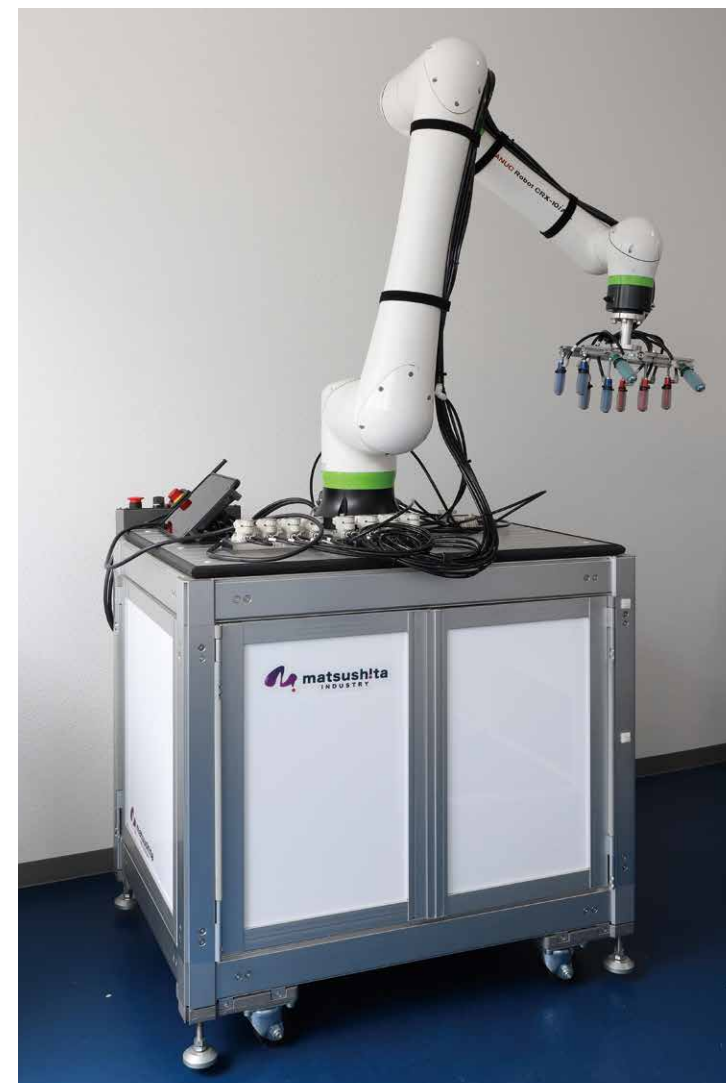
セミナールームの協働ロボットはデモ機兼実験機として、要望に合わせたティーチングやセッティングをし、客先まで運んだ上で現場での試験にも使用されている。
