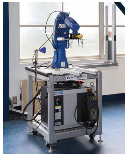
ZF架台に多関節ロボットを載せた実験機。アルミフレームの特性を生かし、都度改造しながら使用している。
