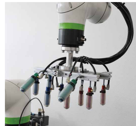
エアーで先端のゴムを膨らませ、ワークを把持する独自開発のMKグリップ。ゴムだけの交換が可能のためランニングコストも抑えられる。
