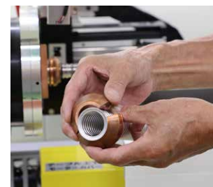
溶接するワークにそれぞれ治具を取り付け、溶接装置にセットする。
