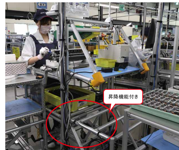
特定の工程だけでなく、多くの作業台に昇降機能を付け、作業者に合わせて調整しながら使用している。短時間で簡単に高さを変更でき、微調整にも対応可能。
