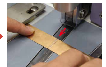
写真中央の溶接箇所(赤矢印部)に盛り上がりや歪みはまったく見られない。
