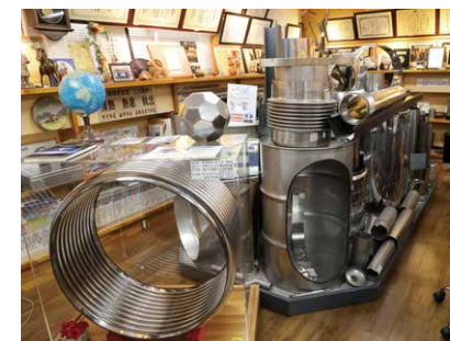
板材を円筒状に溶接したものを中心とする大型のサンプル。その後の加工に耐えられるよう均一な品質が求められる。
