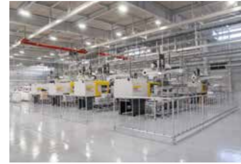
まずは、アルミフレームのキャップなどを製造する樹脂射出成形機8台が稼働。後工程の自動化も進めていく予定です。
