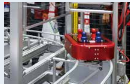
ドリーは、バッテリーを積みアルミパイプ構造材GF製のレール上を走る、デモ用の小型搬送装置でした。
