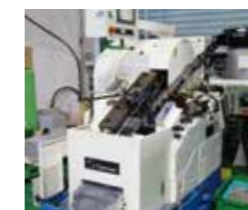
ボルトにネジ溝をつける転造機
