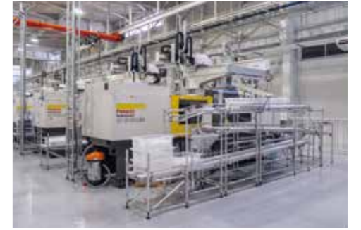
満タンになったコンテナを自動で排出し、ストックするからくりシューターを併用して長時間の無人稼働を可能にしています。
