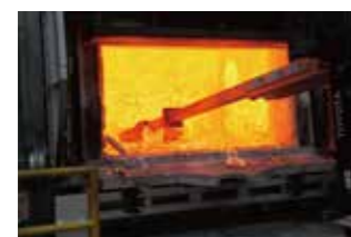
福島事業所製造工場の様子。回収したアルミを溶解し、高品質なビレットに再生します。
