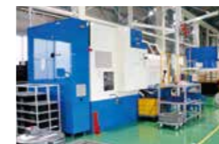
ボルトの形を成形するボルトフォーマー
