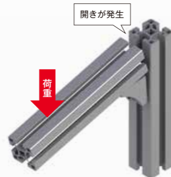
モーメント荷重による開きの発生イメージ
