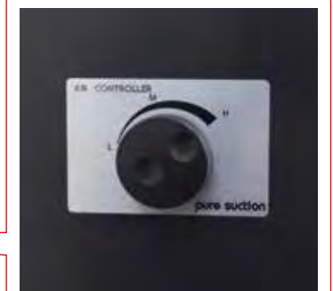
裏面から見たpure suction。吸い込み量をコントロールするボリュームが取り付けられており、操作は非常にシンプル。
