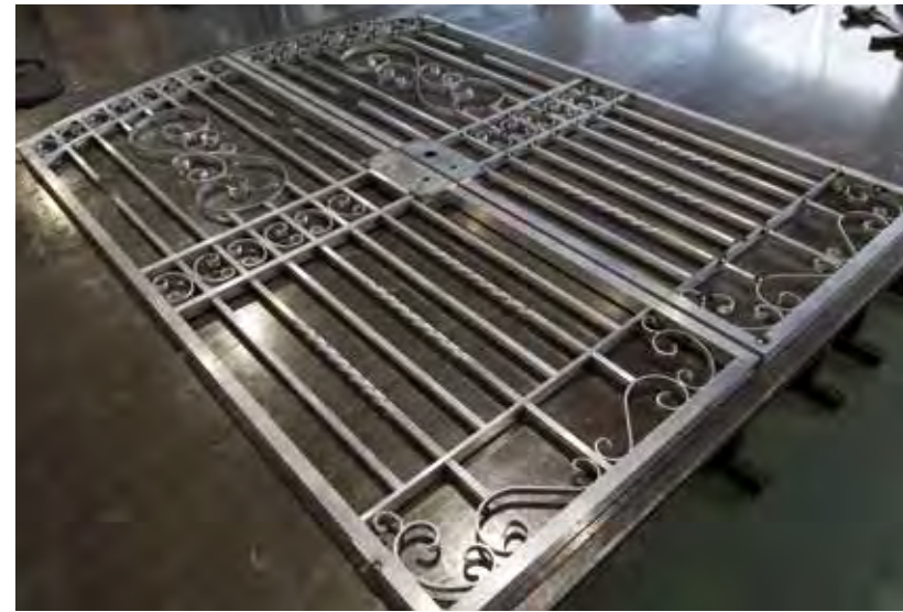
製作中のアルミ製のオーダーメイド門扉。パーツを溶接で組み合わせ、最後に粉体塗装を施す。
